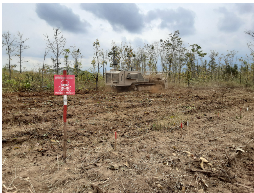
写真 2: ”中型地雷ウルフ”機械操縦部隊が、バタンバン州コッス・クラロー郡プレイ・トウン村にある地雷原(BS/CMAA/07141)で撤去活動をしている様子。
